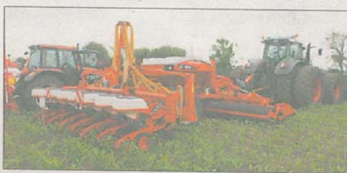
Kuhn såsæt med rotorharve og 8-rækket såmaskine koster over en million kroner. Men sættet kan så majs direkte efter ploven, og såningens kvalitet svarer til gennemsnittet. Foto: Jens Tønnesen.
